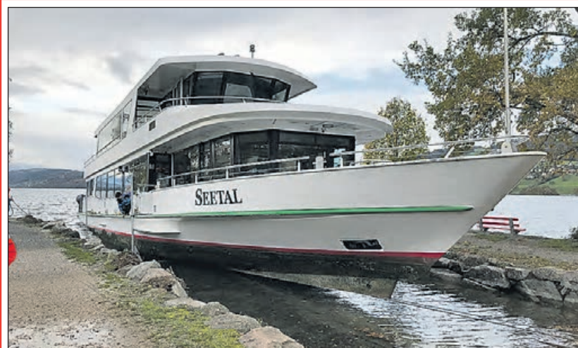
Zeit für ein «neues Outfit»: Die MS Seetal liegt im Zopf Meisterschwanden auf dem Trocken. Das Schiff wird während der Wintermonate vom Scheitel bis zur Sohle generalüberprüft und erhält einen neuen Anstrich – vom Kiel bis zum Oberdeck. (Bild: SGH.)
